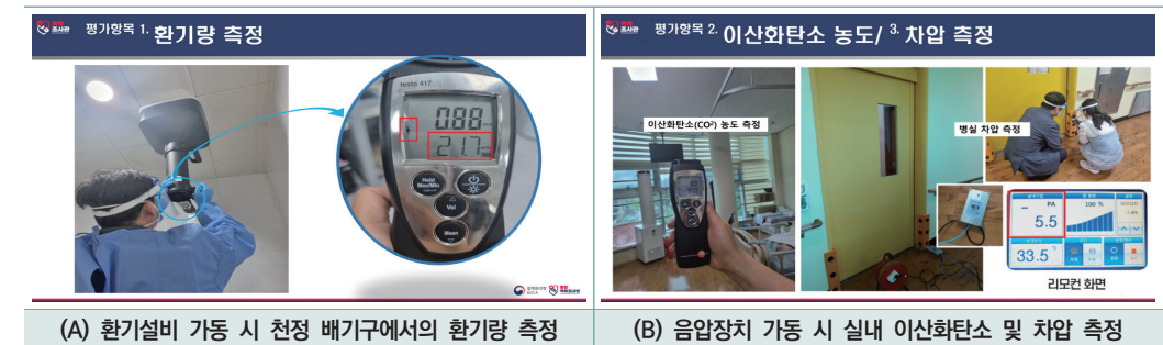
그림 1-24 실내 환기설비 및 장치에 대한 환기 성능 측정
